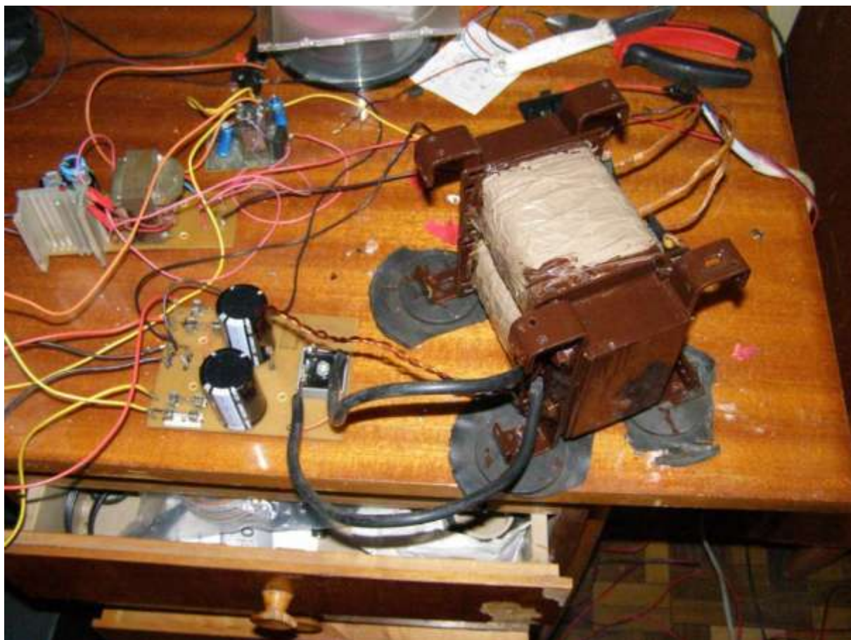
Ezen a képen a végfok trafoja egyeniránítása az előfok tápja és a koppanásgátló látható
