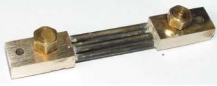
Fot. 5 Rezystor pomiarowy 0,001Ω
