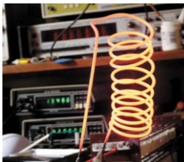
Fot. 4 Rezystor pomiarowy 0,2Ω
