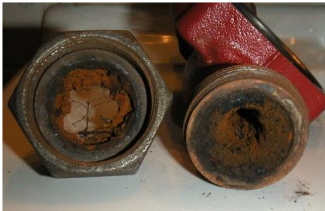
6. kép: egyéves szivattyúház a lerakódott algával és korrozív szennyeződéssel. A szivattyú elődje elromlott. Vajon miért?
