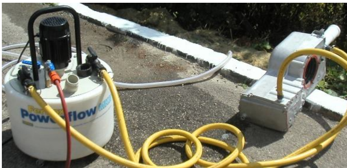
4. kép: vízkőtől teljesen eldugult alumínium hőcserélő tisztítása semleges tisztítószerrel.
