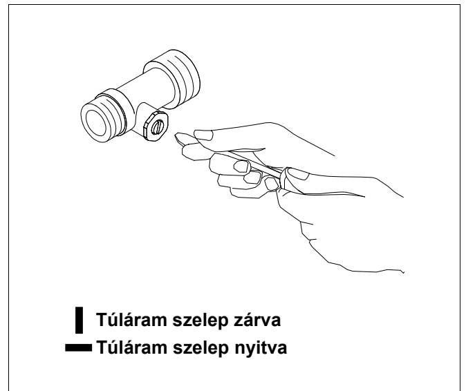
29. ábra A túláram szelep beállítása
