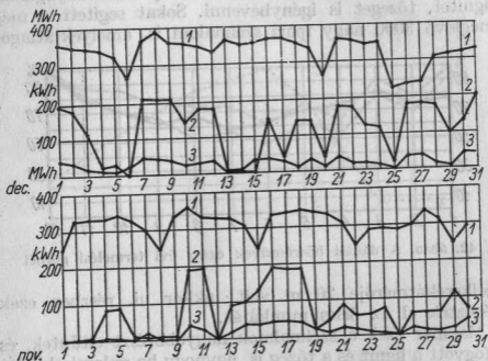
41. ábra. A dániai hőerőművek és a velük együttműködő Bogö- és Gedser-szélerőművek termelési görbéi
