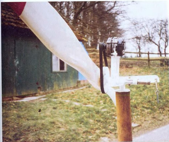
52. ábra. A forgórészfejet és a készre szerelt forgórészt egy csódarabra tesszük és a szabadban elvégezzük az első próbákat
