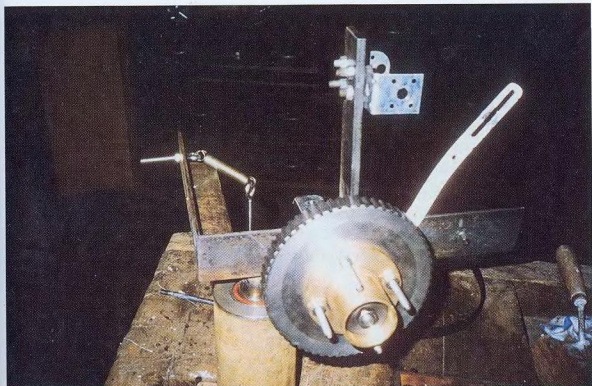
47. ábra. Előlnézet: A már összeszerelt forgórészagy és fogazott tárcsa
