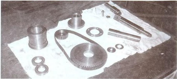
21. ábra. Az ELWI 2 megépítéséhez szükséges forgácsolt alkatrészek Balra az árboccsapágy külső része a golyóscsapágyakkal Középen a két fogazott szíjtárcsa a fogazott szíjjal Középen fent a forgórész agya a benne lévő csapágyakkal, előtte a forgórész felerősítő tárcsája és a tengelyre való csapágytartó tárcsák A jobb szélén a forgórész tengelye, amit az árbocfej keretéhez kell hegeszteni, a szélirányjelző csuklójával együtt, előtte az árboccsapágy belső része, amit szintén hozzá kell hegeszteni a kerethez
