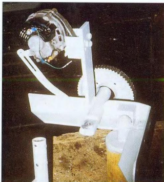
37. ábra. A forgórészfej – röviddel a befejezés előtt, már festett állapotban – próbaképpen egy árboccsövet helyettesítő csődarabra téve. Elöl balra a földre állított szélirányjelző csőve látható; ezt majd a forgórész-tengelynek (szintén az előtérben látható) végével csuklósan kötjük össze
