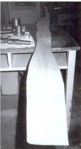
29. ábra. Összeragasztott jegenyefenyő deszkából készített, készre gyalult kísérleti légcsavar
