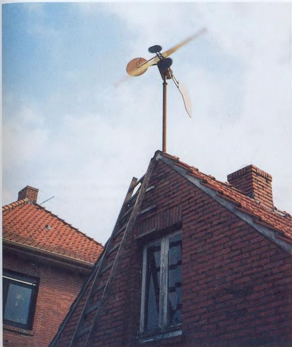
2. ábra. 1,8 m átmérőjű szélkerék (Tervezte: Christian Kuhtz )
