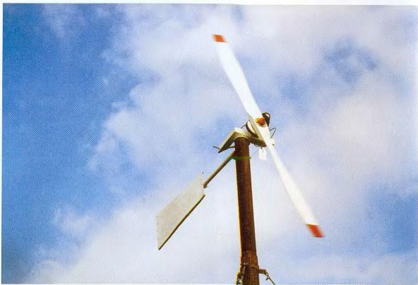
22. ábra. A készre szerelt ELWI 2 az acélső árbocon
