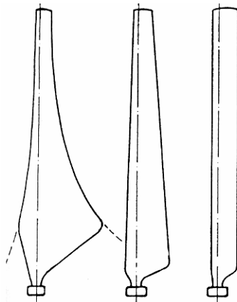
Lapátprofilok a sugár (hossz) mentén
