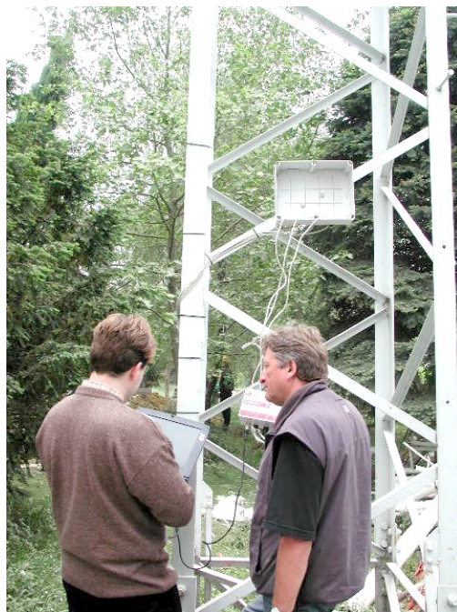
d) Az adatrögzítő kiolvasása (Rácsos mérőállvány)
