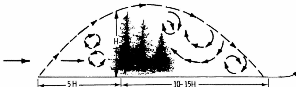
2.17 ábra Magas fasoroknál turbulencia lép fel (különösen a mérőállomások telepítésénél fontos).
