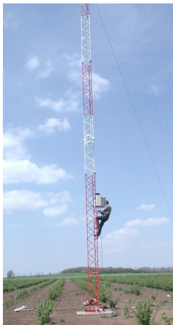
c) Az adatrögzítő kiolvasása (Komárom, Rácsos mérőállvány)
