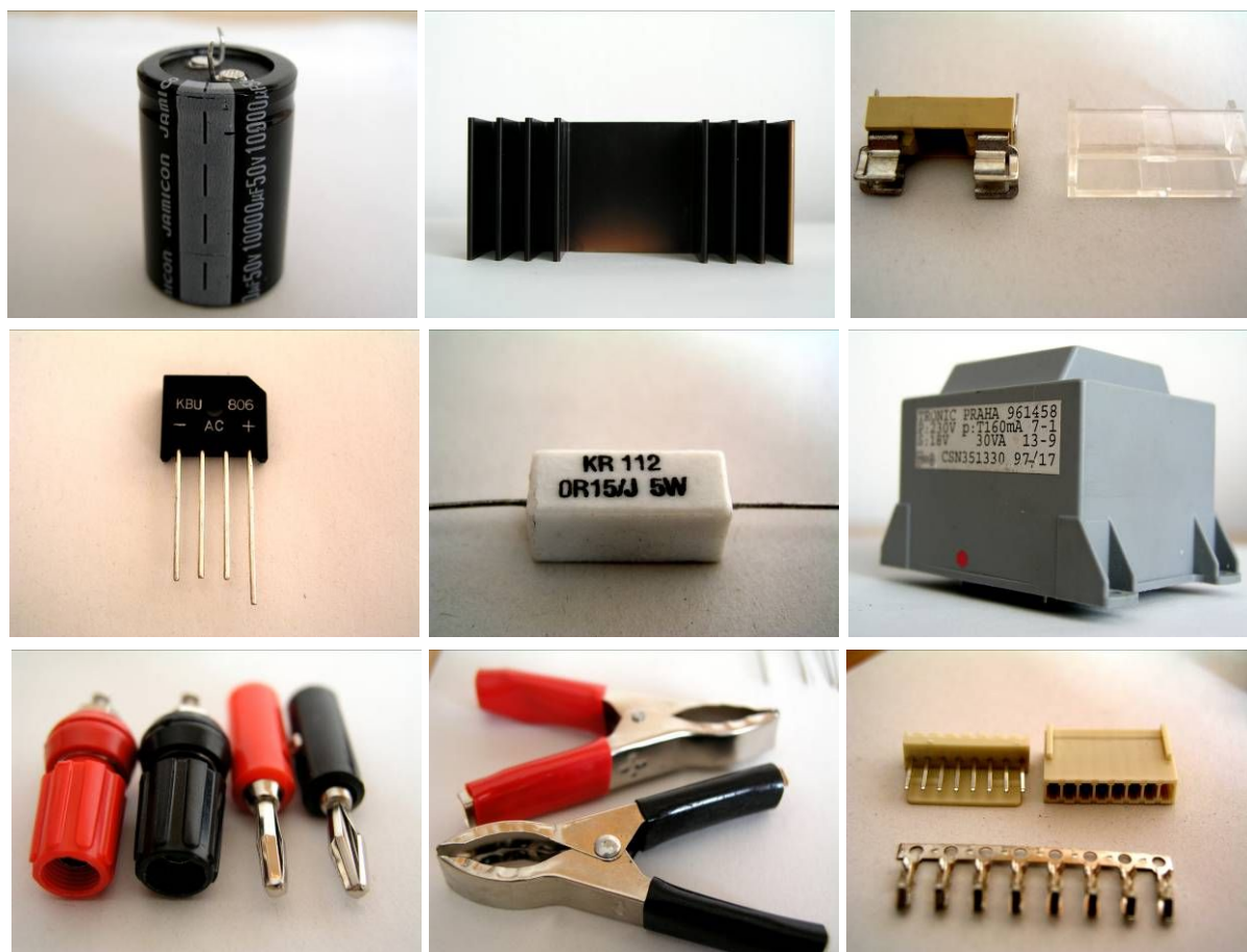
Fotografie konstrukčních prvků (kondenzátor, chladič, diodový můstek, transformátor,...)
