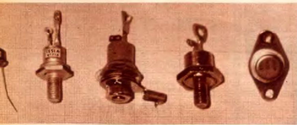
Különböző típusú tirisztorok (balról jobbra): Tesla 1 A 400 V, Tesla 3 A 400 V, CKD 16 A 600 V, Siemens 16 A 400 V, USA 6 A 400 V
