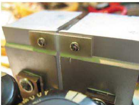
Fot. 5 Łącznik izolacyjny
