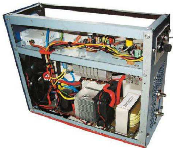
Fot. 9 Rozkład modułów w obudowie
