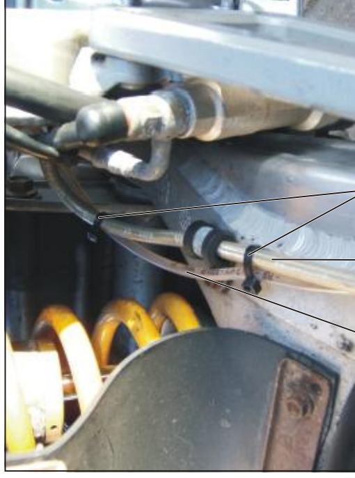
Bild 10 Verlegung der Ölleitung parallel zur Bremsleitung nach oben zur Steuerung
