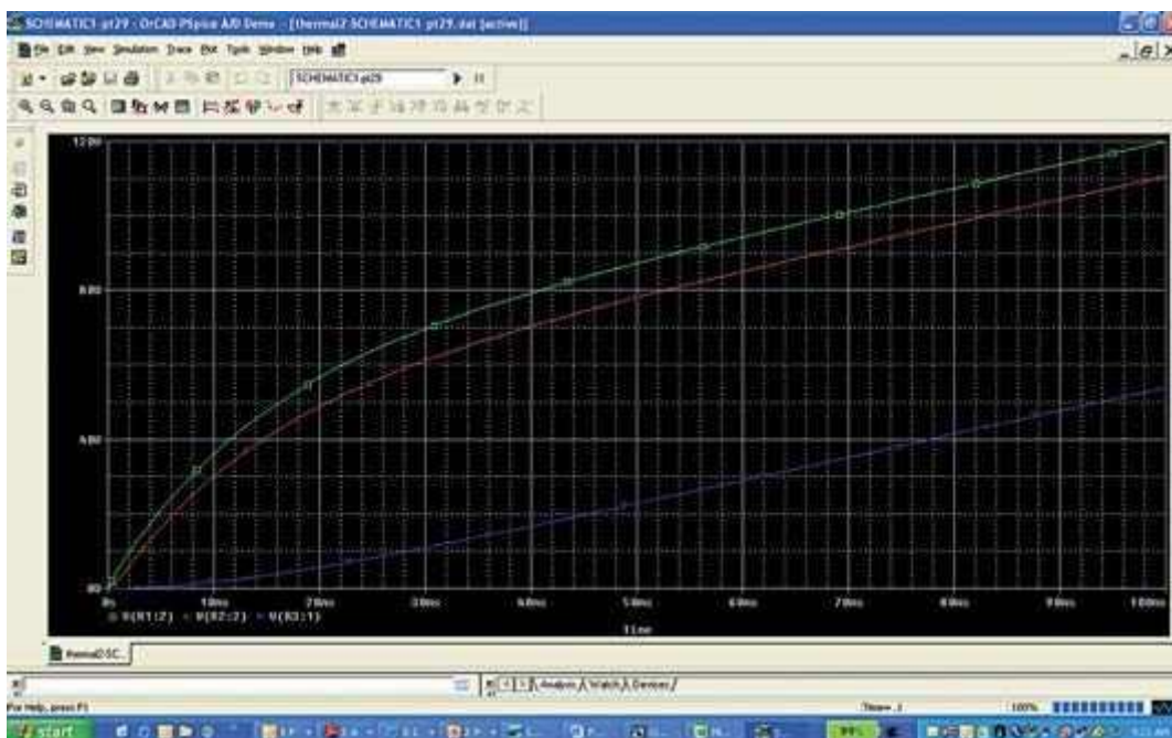
2. ábra Három időállandó hatása észlelhető a csiptől a NyÁK-lapig vezető hőenergia-áramlásban
