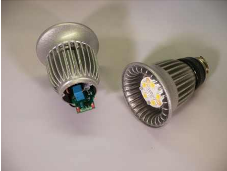
1. ábra Egy izzólámpahelyettesítő tokozatban nagyon kis hely van a tápegység számára
