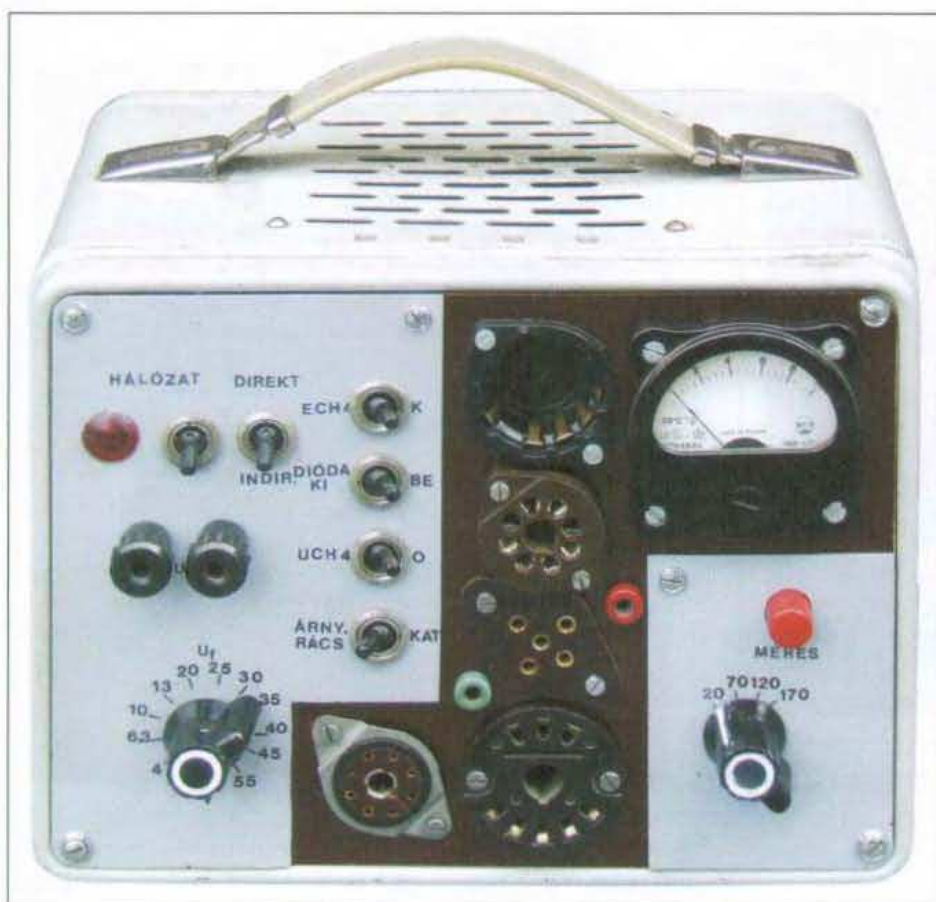
8. ábra. Utánépített nagyáramú emissziómérő
