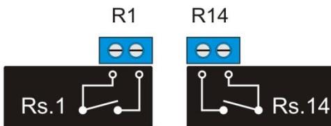
**Rs.1 / R1** – Relay for Spindle Motor / max.8A / 230V. (*Relais für Fräsmotor / max.8A / 230V.*)
