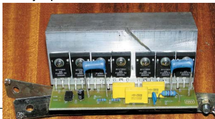
Fot. 3 Płytką prostownika
