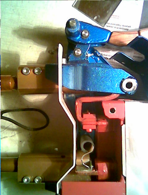
Obě ramena jsou elektricky izolována od konstrukce . Pro zabezpečení ochrany při případném průrazu primáru do sekundáru ,je tento na jedné straně spojen s kostrou pár závitů topného drátu o odporu jednotek desetin ohmu.
