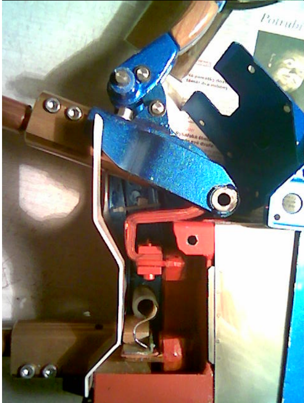
Obě ramena jsou elektricky izolována od konstrukce . Pro zabezpečení ochrany při případném průrazu primáru do sekundáru ,je tento na jedné straně spojen s kostrou pár závitů topného drátu o odporu jednotek desetin ohmu.
