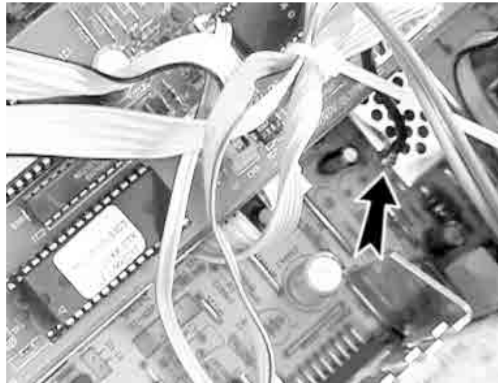
Masseleitung anlöten / Solder on ground cable
