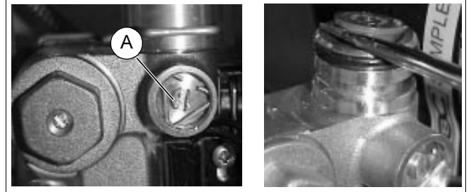
1. ábra Az átfolyó vízmennyiség beállítása
