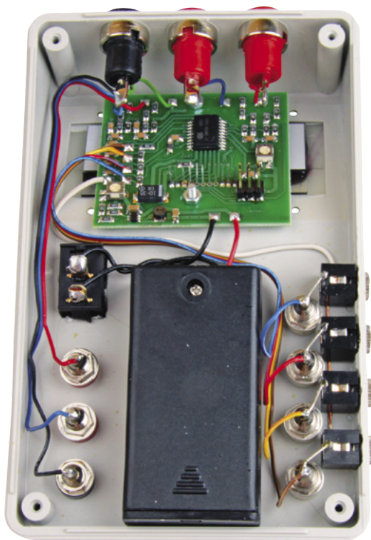
Fotografia 4. Pojemnik na baterię zamontowany wewnątrz obudowy miernika
