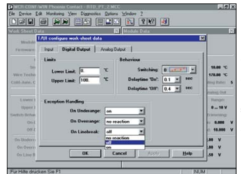
Konfiguration des Transistorschaltausganges des MCR-T-UI-...-Modules
