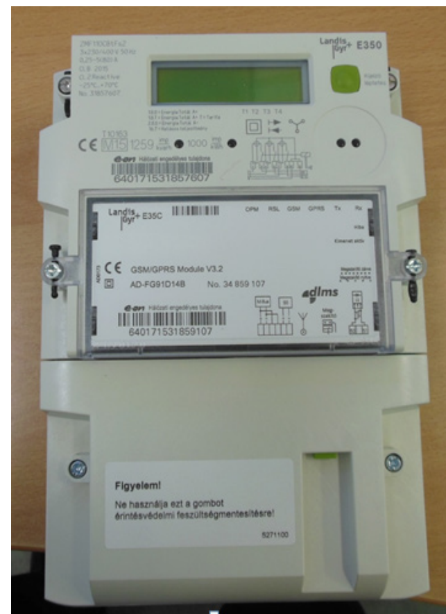
3 fázisú, típusa, E350 3x5-80 A Kommunikáció: GPRS.
