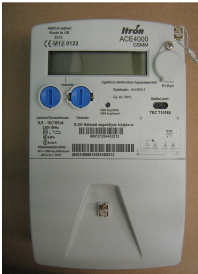
1 fázisú, típusa: ACE4000GSMM 10-100 A Kommunikáció: GPRS.
