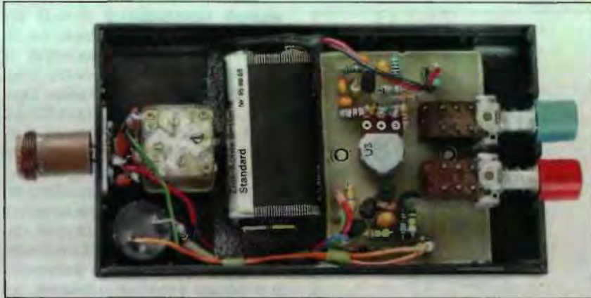
3. ábra. A GDO belső felépítése (alulnézet)
