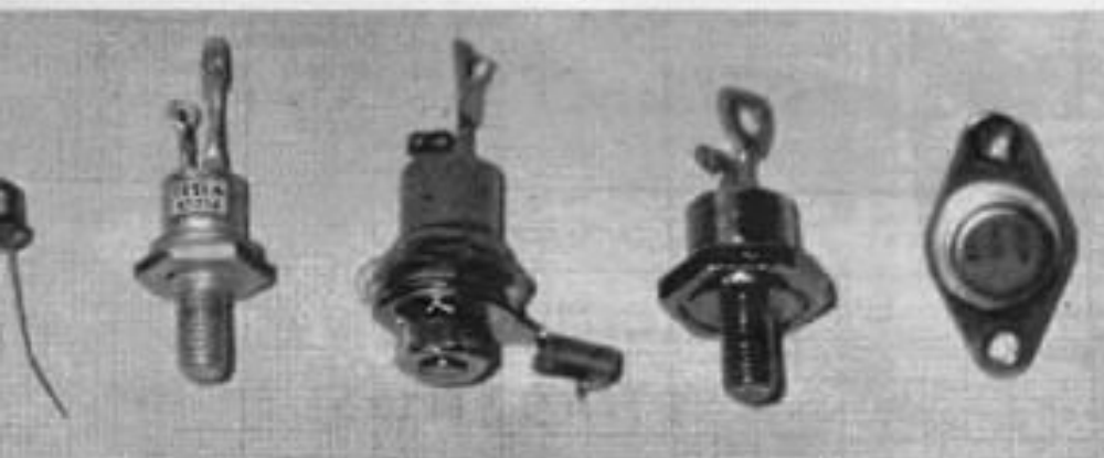
Különféle tirisztorok (balról jobbra): Tesla 1 A 400 V, Tesla 3 A 400 V, CKD 16 A 600 V, Siemens 16 A 400 V, USA 6 A 400 V
