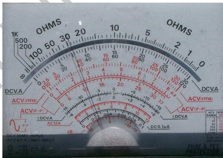
4. ábra. A mutató leolvasásakor fellépő parallaxis hiba
