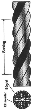
Abb. 7.3 Aufbau einer HF-Litze
