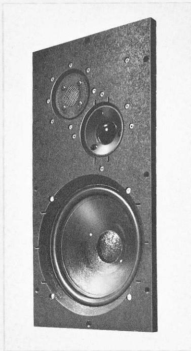
Die AX 4-3 ist als passives Dreiwegsystem konzipiert. Damit liessen sich grosse Belastbarkeit und Überlastreserve bei gleichzeitig hoher Empfindlichkeit realisieren. Schon bei der überaus geringen Klemmspannung von 1 V (0,25 Watt) erzeugt die Box AX 4-3 einen Schalldruck von mehr als 80 dB. Das bedeutet: auch im extremen Anwendungsfall ist kein «Kraftwerk» an Verstärker erforderlich.
